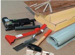
La distancia mínima hacia las paredes deberá ser 10 mm (la distancia separadora para áreas muy grandes será de 1,5 mm por cada metro de ancho). Utilice para este efecto los tacos distanciadores, los cuales deberán ser eliminados después de acabada la colocación completa.
