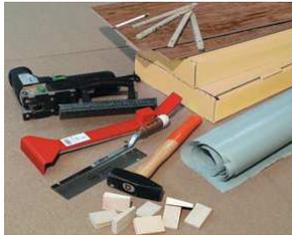
Para comenzar se necesita: Película de polietileno y cinta adhesiva. Como herramientas: metro plegable, lápiz, sierra de calar, martillo pesado (mazo), regla para nivelar, hierro de tracción, taco de madera y cuñas distanciadoras.
